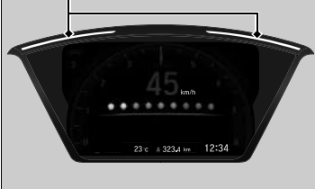
Bakgrundsbelysning vid uppväxling
